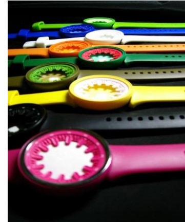
使用真空浇注制作的产品样件
