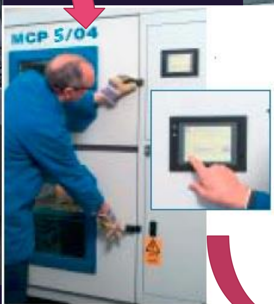
PLCによるコンピューター制御カプロラクタム(PA6)注入
