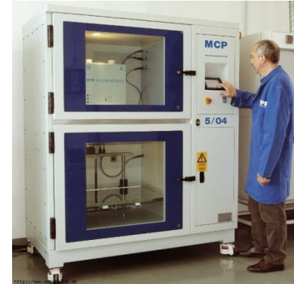
写真4: ナイロン注型装置 外観
