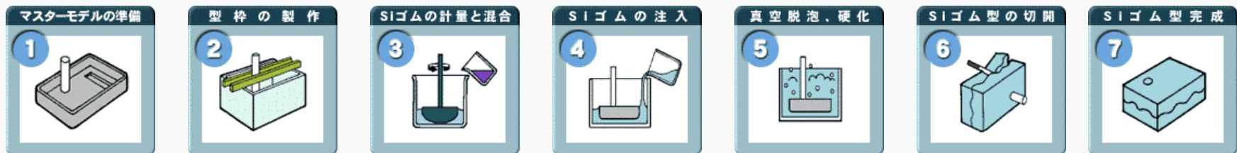
図1： ◆シリコン型作製工程
