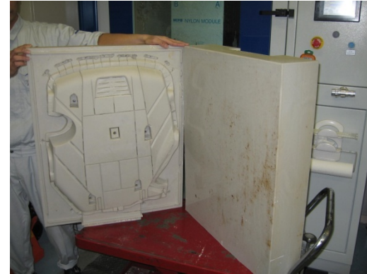
写真7: ナイロン注型品用のシリコン型
