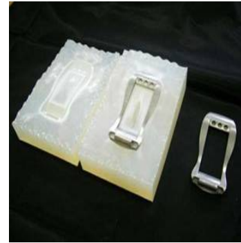
写真2: シリコン型と注型品
